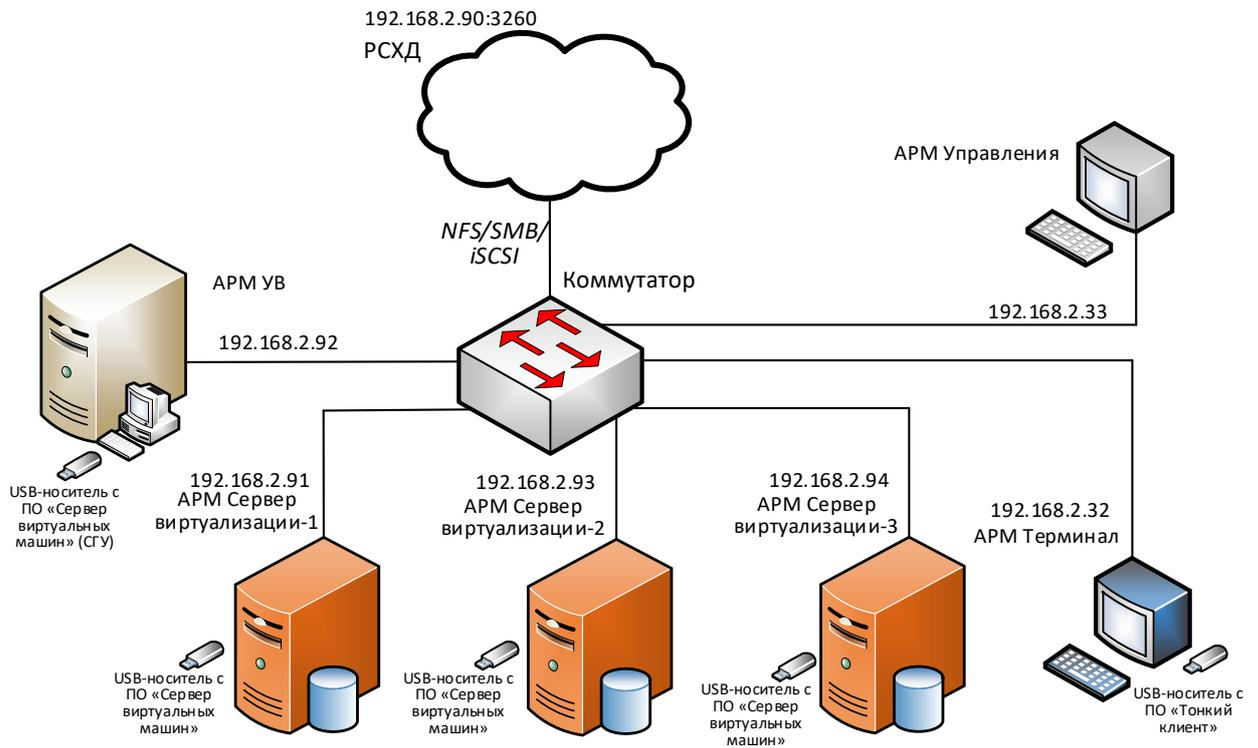
Рисунок 1 – Пример схемы стенда
